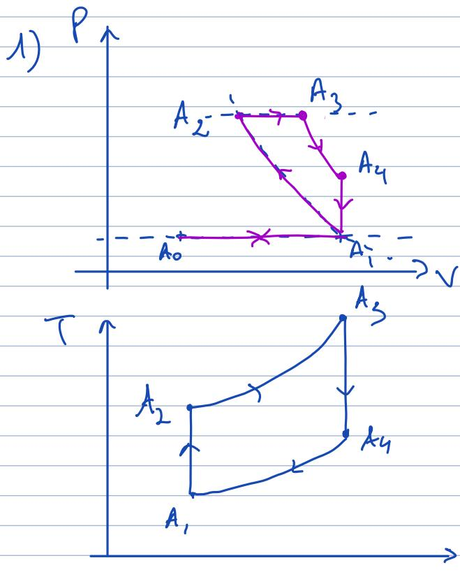
Les transformations  $A_1 \rightarrow A_2$  et  $A_3 \rightarrow A_4$  sont adiabatiques et réversibles et sont donc représentées par des hyperboles de paramètre  $\gamma$ . dans le diagramme  $(P, V)$  et des droites verticales (isentropiques) dans le diagramme  $(T, S)$
